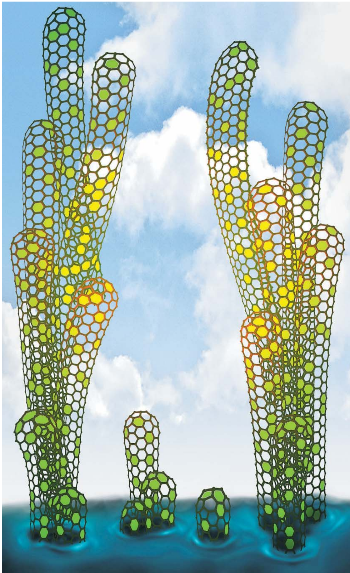
Die Modellzeichnung zeigt, wie auf einer Platinoberfläche Kohlenstoff-Nanoröhrchen allmählich emporwachsen. Bis zu 300 Nanometer lange Röhrchen können in einem solchen Prozess entstehen, berichten Wissenschaftler vom Schweizer Forschungsinstitut Empa in Dübendorf und vom Max-Planck-Institut für Festkörperforschung in Stuttgart im Fachmagazin „Nature“.
