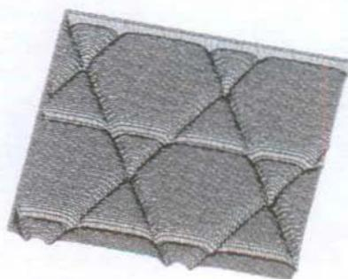
Abb. 33: 2-D Plot der Oberflächenkorrugation; Netzwerk aus Stufenversetzungen mit 3-zähliger Symmetrie. Berechnet nach Gl.(5.2) mit den Parametern:  $d=2 \text{ \AA}$ ,  $z=0.3 \text{ \AA}$ ,  $\delta=0.35$ .
